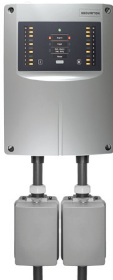
Filtr przeciwpyłowy DFU 911S ze zintegrowaną kłapką ochronną
